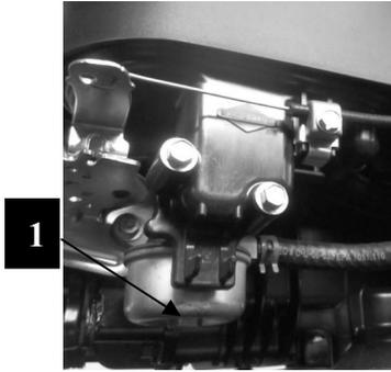
Videz le réservoir de carburant en retirant la vis située au bas du filtre à carburant (1) et récupérez le carburant dans un récipient approprié.
