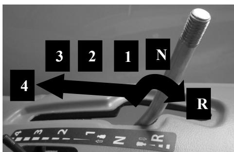
Ce levier a six positions pour les quatre vitesses avant, la position neutre «N» et la marche arrière «R».
