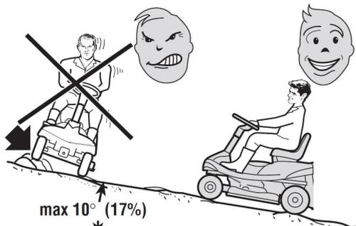
**DANGER** Ralentissez avant de changer de direction sur les pentes. N'utilisez jamais la marche arrière pour réduire la vitesse en descente: vous risquez de perdre le contrôle de la machine, en particulier sur les surfaces glissantes. Ne conduisez jamais la machine sur des pentes au point mort ou avec l'embrayage sorti! Engagez toujours un rapport bas et le frein de stationnement avant de laisser la machine à l'arrêt et sans surveillance.
