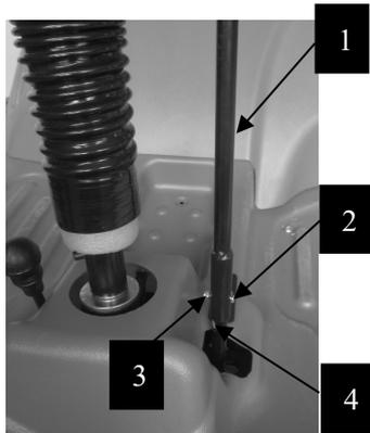
Montez l'extrémité du levier (1) sur la partie de la goupille (2) et fixez le tout en serrant les vis (3) et écrou (4)
