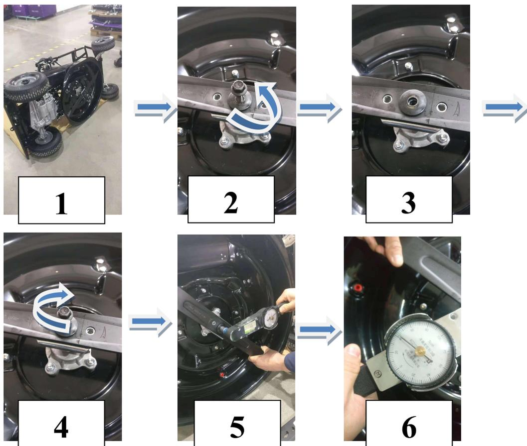
1. Assurez-vous qu'il n'y a pas d'huile et d'essence pour machine dans le réservoir, posez la machine sur le côté comme illustré ci-dessus.
