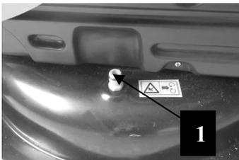
**a)** Lors du lavage de l'intérieur du plateau de coupe et du canal collecteur, la machine doit être sur un sol ferme:
